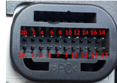
Brochage du connecteur accessoire côté radio:
