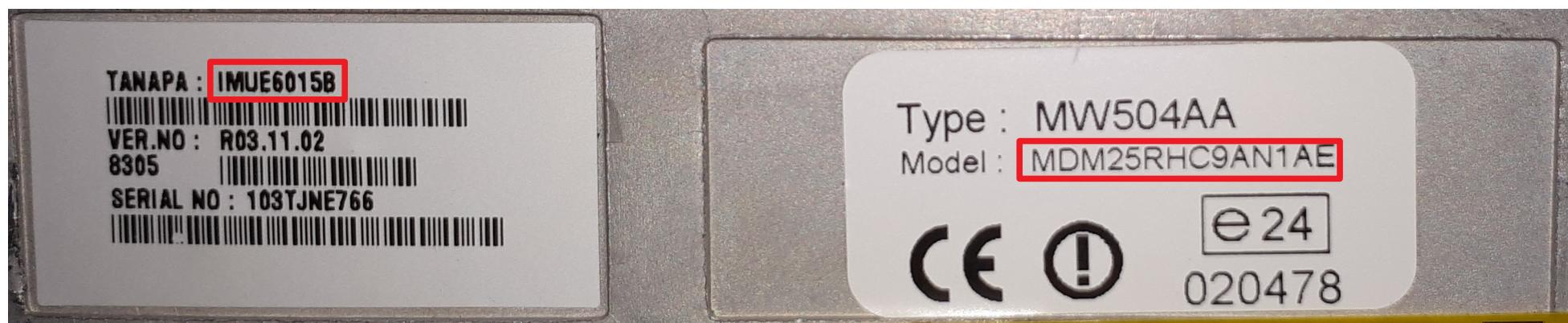
Le TANAPA est donc « IMUE6015B » et le modèle « MDM25RHC9AN1AE ».
