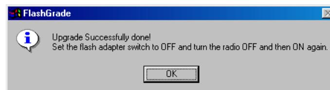
La radio peut être mise hors tension. L'interrupteur de la FlashRIB doit être remis sur la position « Perso » pour la suite des opérations.
