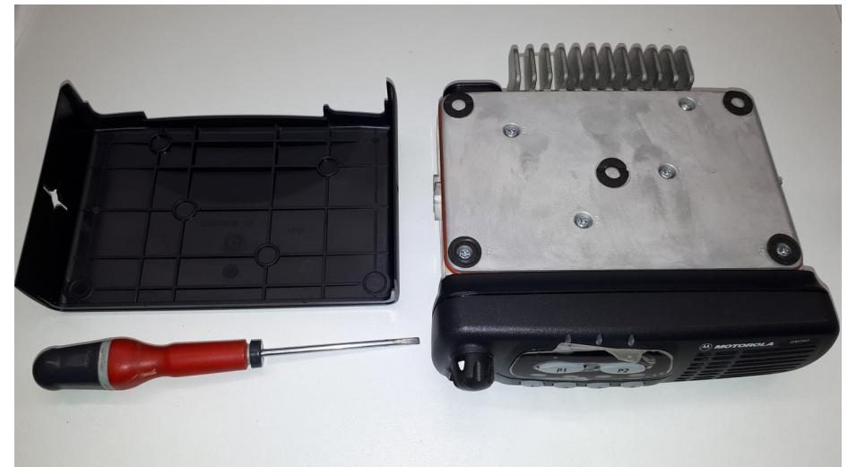
Dévisser les 6 vis Torx du capot avec une clé Torx T20 et lire le code d'identification du circuit imprimé :
