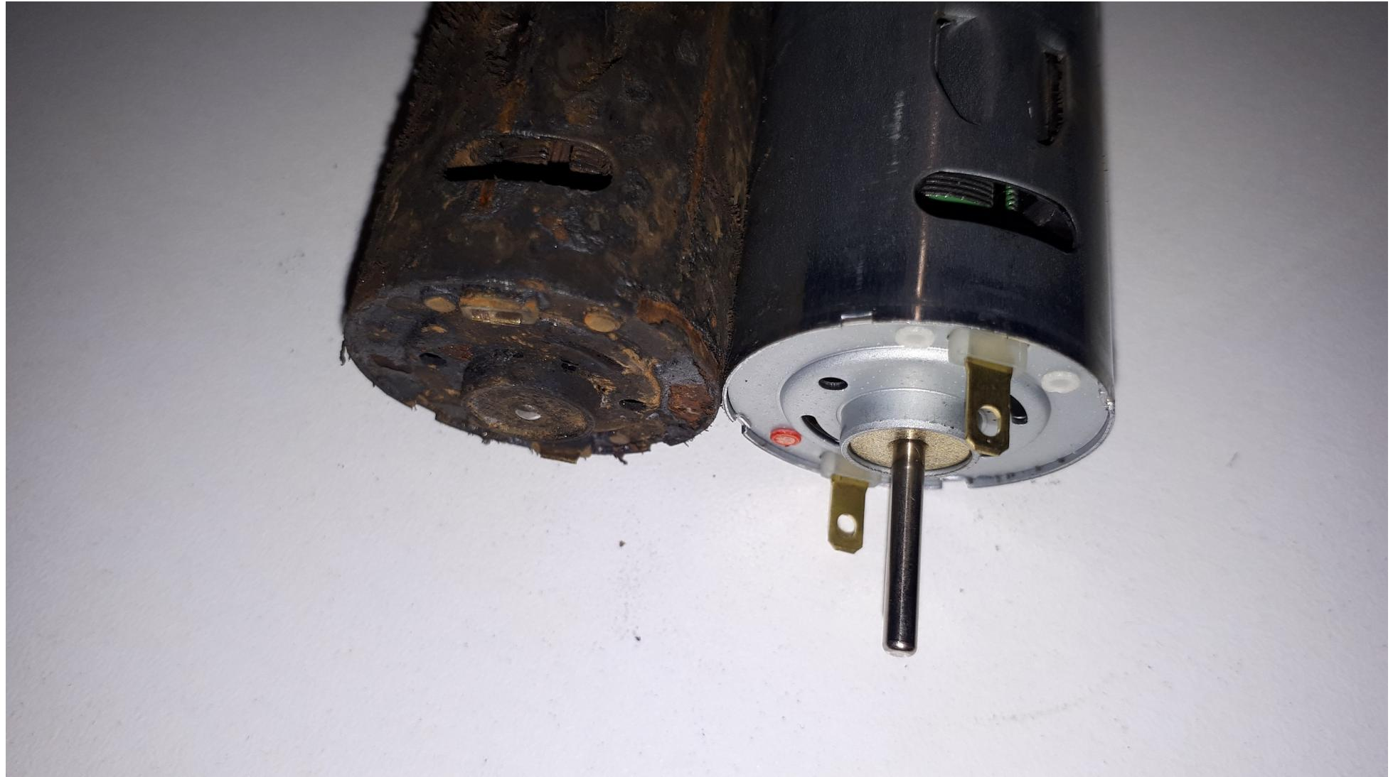
Et encore les mêmes découpes oblongues courbées d'aération en dessous, les trous de part et d'autre des découpes, et le support des connexions électriques !
