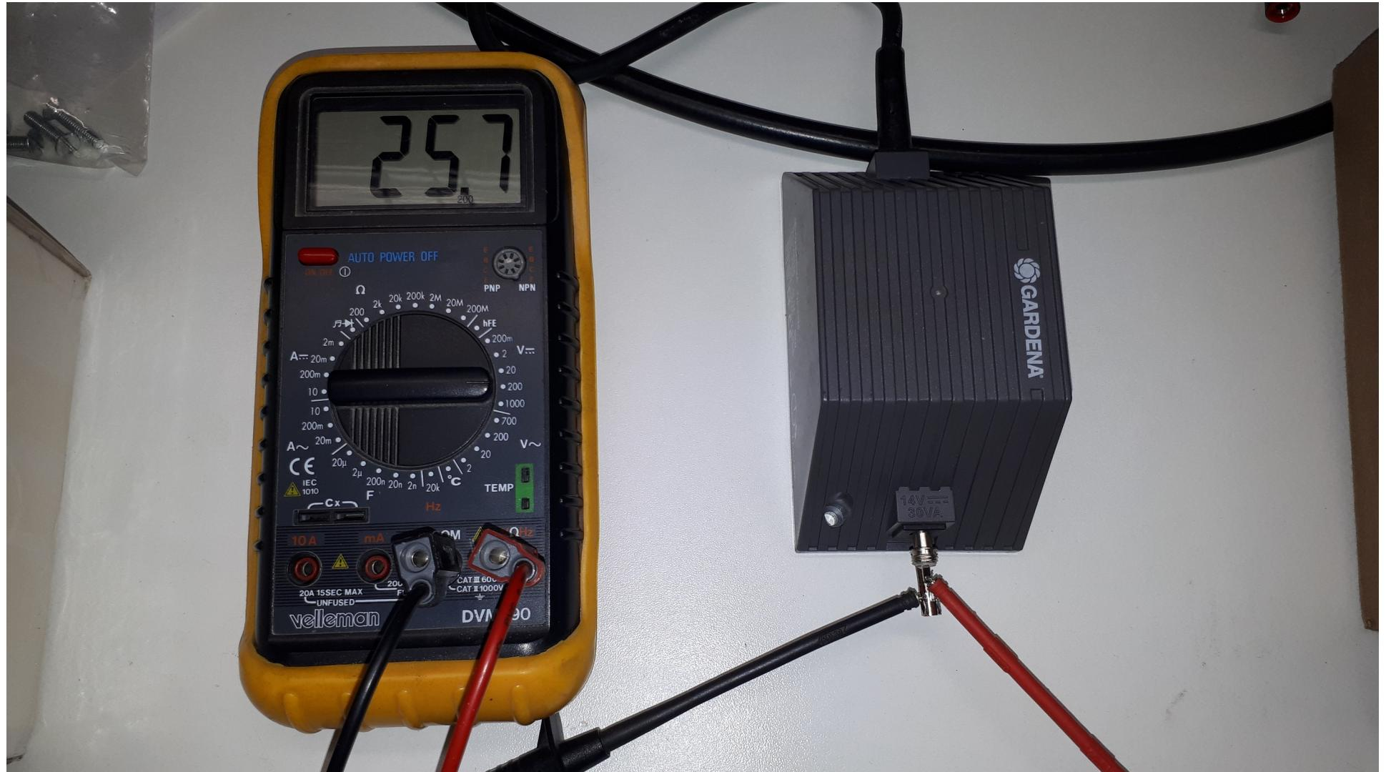
Le moteur encaisse l'écart de tension visiblement. Le courant consommé monte à 0,14A, ce qui engendre une petite chute de tension en sortie du transformateur :
