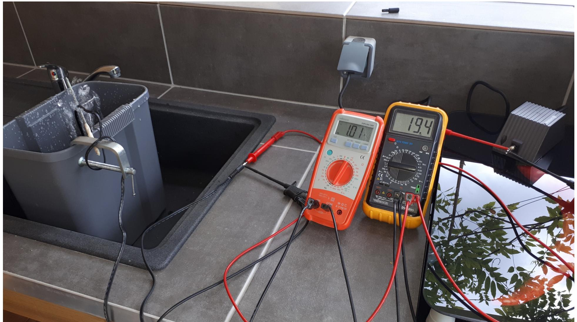
La tension en sortie du transformateur temporisé a encore chuté, car la consommation est encore plus importante. Il faut aspirer de l'eau et l'éjecter par les trois sorties, ça demande au moteur de forcer un peu plus, mais il tient bien le choc. On voit bien l'eau jaillir au dessus du bac. Ce n'est pas un jet à haute pression, mais le résultat est plus que satisfaisant.
