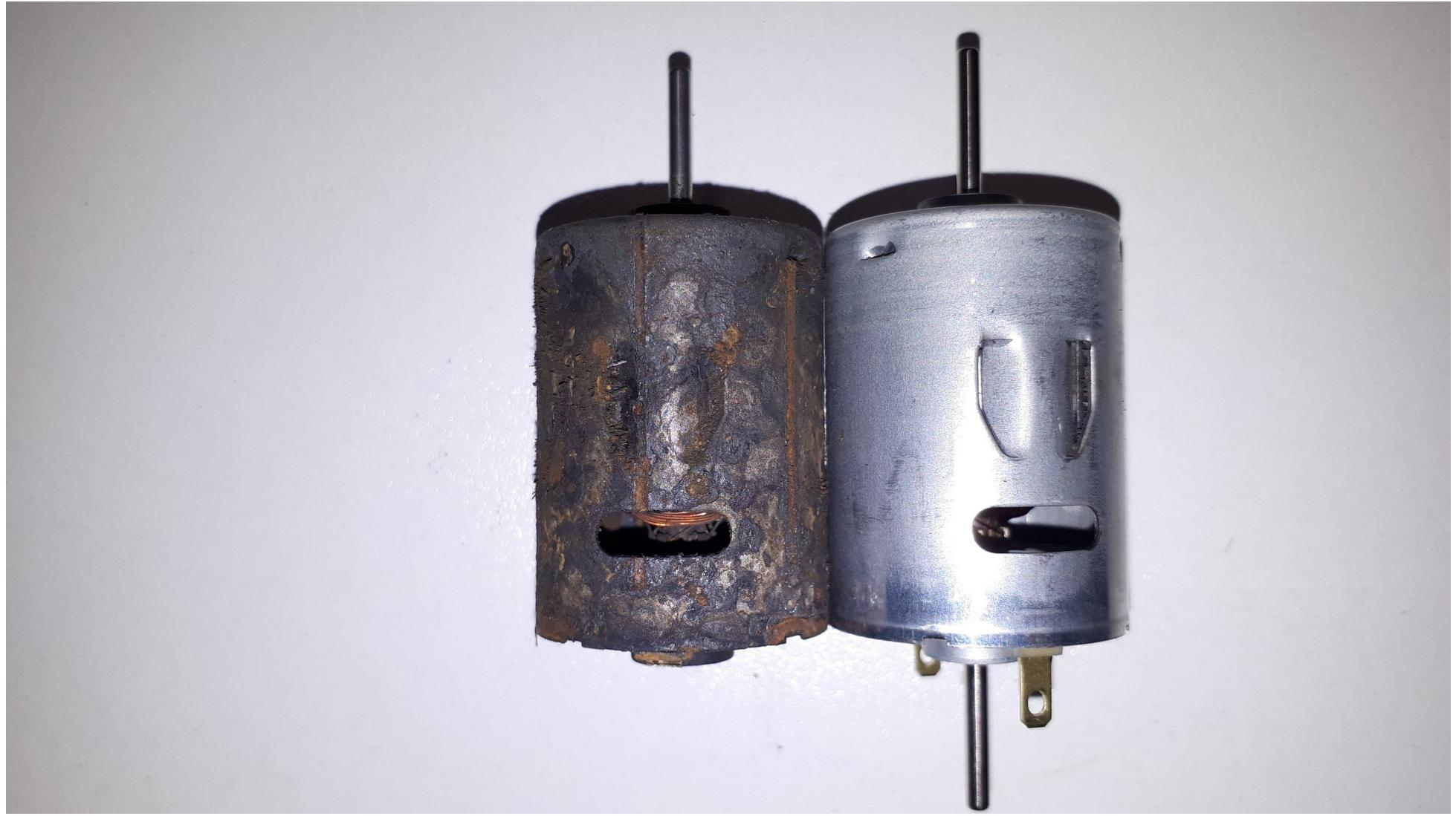
Idem pour la découpe oblongue en bas servant d'aération aux enroulements, les parties embouties au milieu et en haut du corps du moteur !
