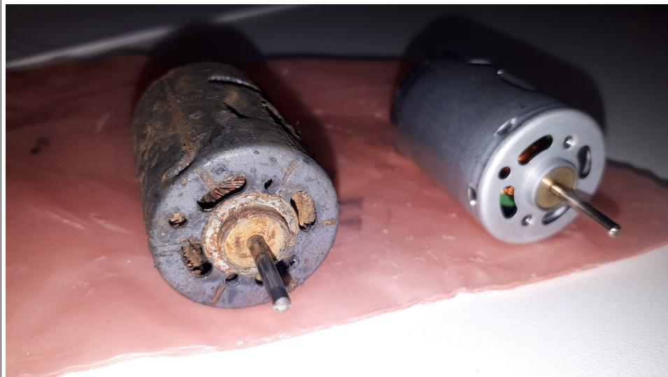
Les trois trous de fixation (non utilisés pour l'assemblage), les découpes oblongues courbées, l'embase de l'axe sur le corps du moteur, tout est identique !
