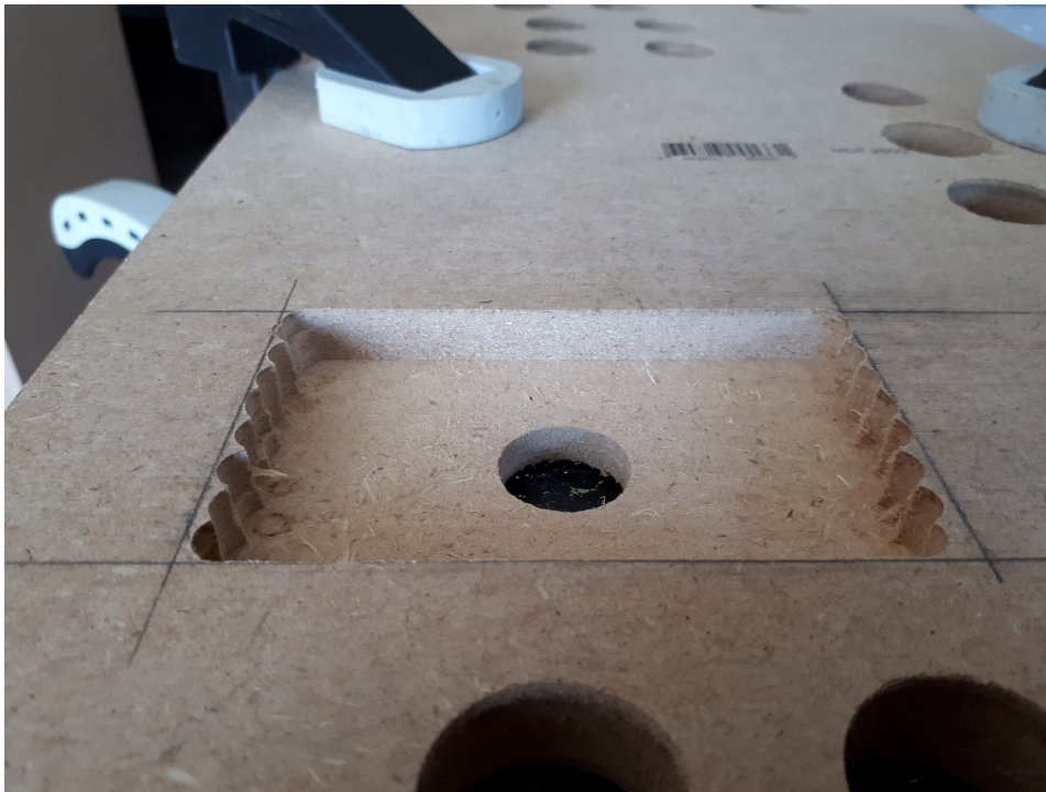
Premier passage, dans une direction. On voit que la découpe est constituée de plusieurs rainures de la largeur de la fraise.
