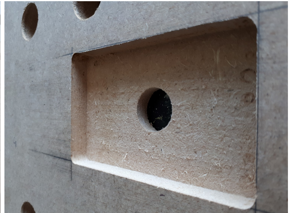
Second passage dans l'autre direction, uniquement sur les deux côtés courts. Le résultat est très propre alors que j'utilisais une défonceuse pour la première fois !
