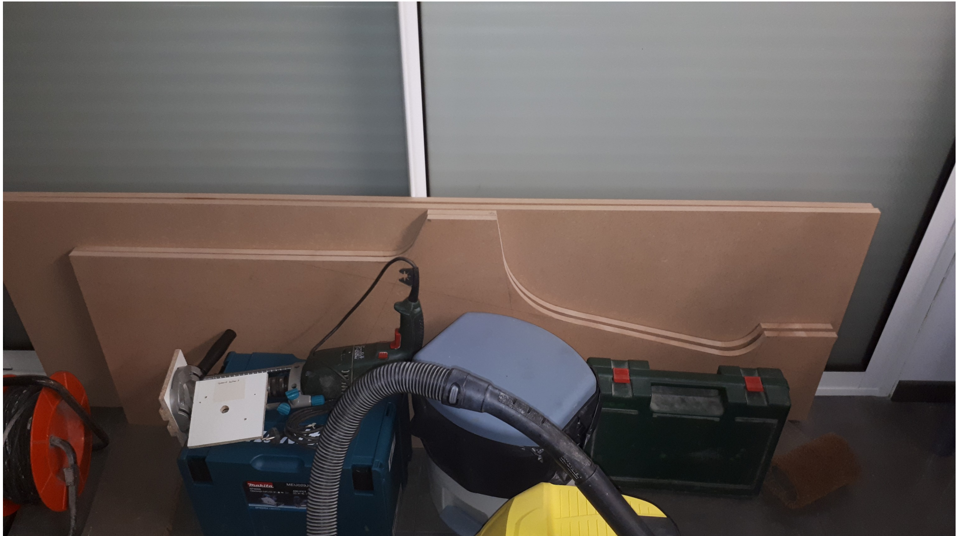
Les deux côtés déjà rangés, parfaitement identiques, avec leurs découpes arrondies effectuées à la scie sauteuse.
